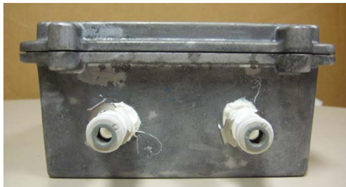
图2：装有压力和温度传感器探头的铝制外壳
