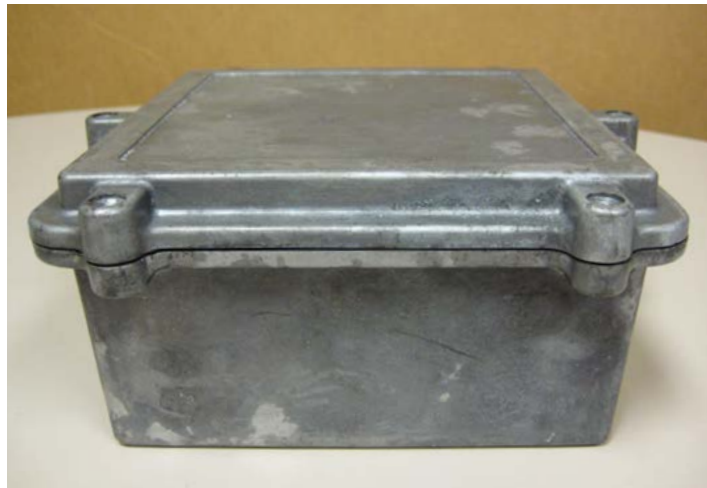
图1：测试中使用的铝制外壳
