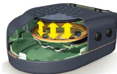
压力增加导致声学器件偏置
